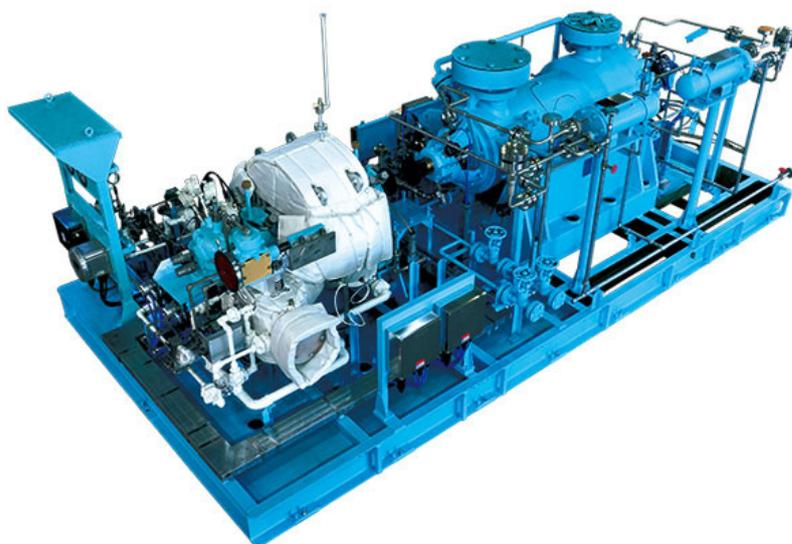
《参考画像》今回納入予定機器と同型式のポンプ及び駆動用蒸気タービン（機器連結状態）
